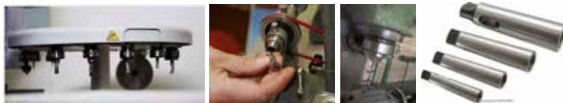
شکل ۴-۲- کاربرد سوراخ مخروطی در دستگاه‌های فرز
