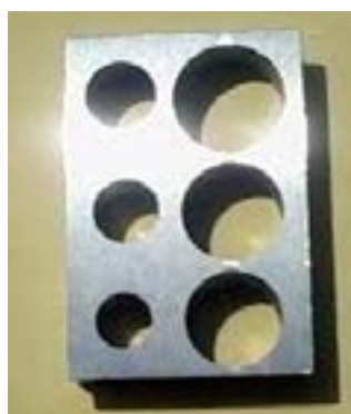
شکل ۴-۲۲- قطعه کار پس از عملیات برقکاری
