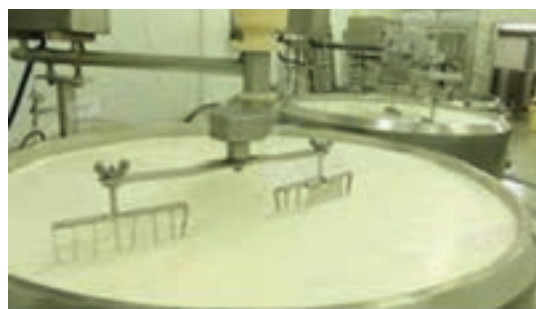
شکل ۴-۴- آب‌گیری و برش لخته
