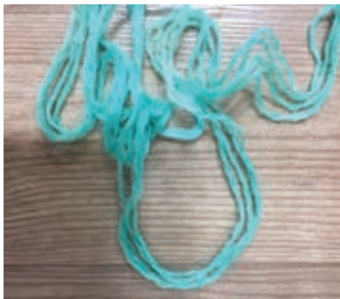
رنگرزی نامرغوب نخ
