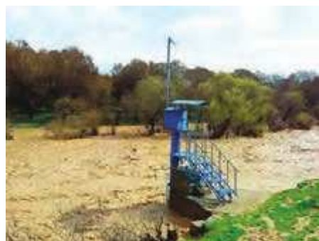
شکل ۳-۲- ایستگاه اندازه‌گیری آبدهی رود
