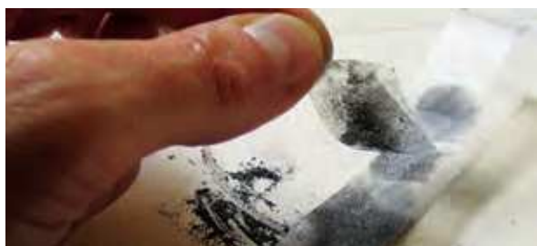
شکل ۴- تهیه گرافن با استفاده از نوار چسب
