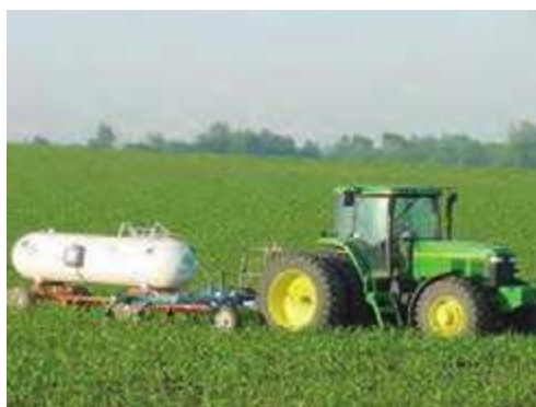
شکل ۶- در برخی کشورها برای افزایش بازده فراورده‌های کشاورزی، آمونیاک مایع را به عنوان کود شیمیایی به‌طور مستقیم به خاک تزریق می‌کنند.
