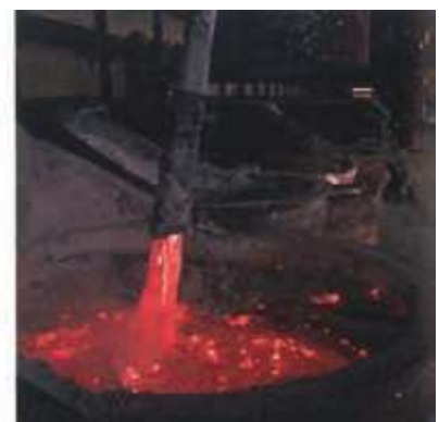
شکل ۱۸- فرایند هال برای تولید آلومینیم از \text{Al}_2\text{O}_3
