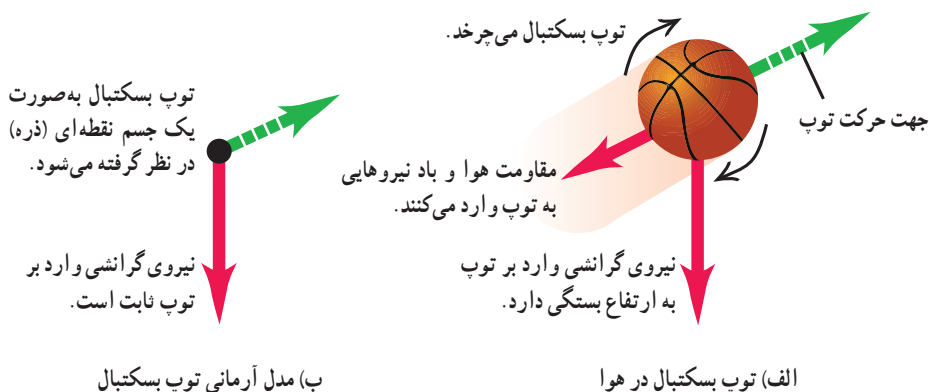
شکل ۱-۳ استفاده از یک مدل آرمانی برای ساده‌سازی تحلیل حرکت یک توپ بسکتبال در هوا
