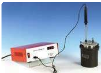
شکل ۷-۴ در این تصویر دمای یک گرماسنج به روش الکتریکی اندازه‌گیری می‌شود.
