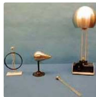
شکل ۱-۲۸ اسباب آزمایش چگونگی توزیع بار روی سطح خارجی یک جسم رسانای بارداری
