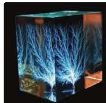
شکل ۳۸-۱ نقش‌های لیچنبرگ. فروریزش الکتریکی باعث تشکیل مسیرهای رسانشی سرخس شکلی در دی الکتریک شده است.
