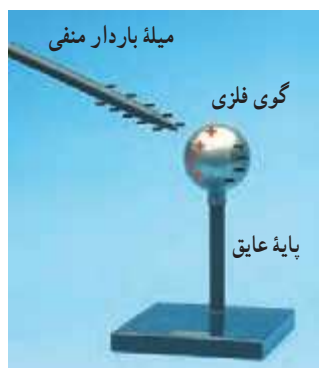
شکل ۱-۲۷ نزدیک کردن میله‌ی بارداری منفی به گوی فلزی خنثایی که روی پایه‌ی عایقی قرار گرفته است، موجب ایجاد بارهای القایی مثبت و منفی در دو طرف گوی فلزی می‌شود.
