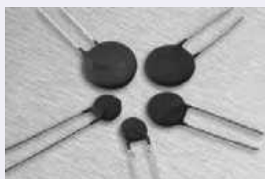
(ب) تصویری از چند ترمیس‌تور دیسکی واقعی
