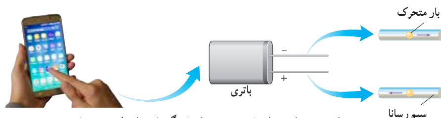
شکل ۲-۱ انرژی از باتری به صفحه نمایشگر تلفن، از طریق سیم‌های رسانایی که در آنها بارهای الکتریکی در جریان‌اند، منتقل می‌شود.
