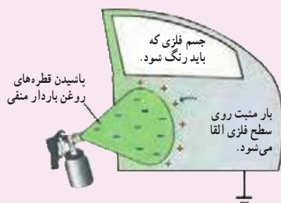
(ب) اساس این رنگ پاشی مبتنی بر پدیده القای بار الکتریکی است.
