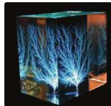
شکل ۴۵-۱ نقش‌های لیچنبرگ. فروریزش الکتریکی باعث تشکیل مسیرهای رسانشی سرخس شکلی در دی الکتریک شده است.
