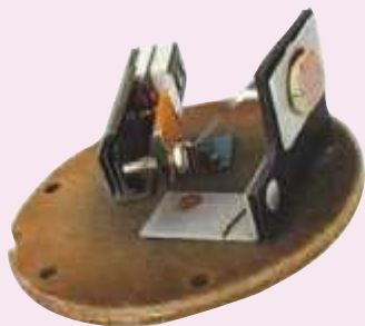
شکل ۲-۳۳ اجزای داخلی یک مدار کنترل‌کننده نوری، که در نوعی از چراغ‌های روشنایی خیابان‌ها استفاده می‌شود.
