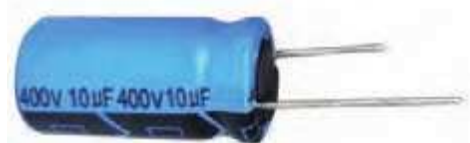
شکل ۴۶-۱ تصویری از یک خازن که روی آن ظرفیت و اختلاف پتانسیل پیشینه قابل تحمل نوشته شده است.
