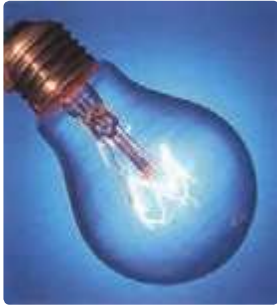
شکل ۲-۱۳ عبور جریان از رشته (فیلامان) تنگستنی موجب درخشش لامپ حبایی شده است.
