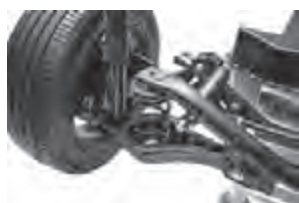
شکل ۲-۱۴ فنرهای به کار رفته در چرخ‌های خودرو
