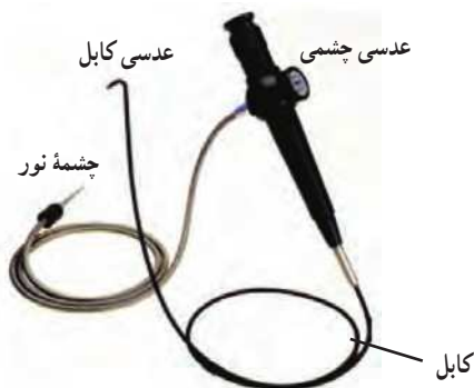
دو دسته تار نوری داخل کابل قرار دارد.
