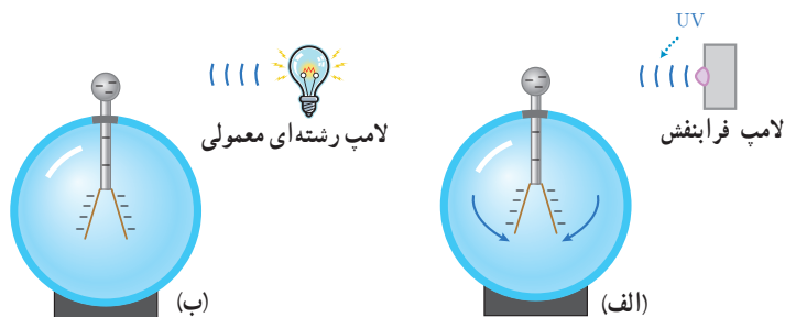
شکل ۱-۵-۱ الف) برهم‌کنش نور فرودی فرابنفش با کلاهک برق‌نما سبب می‌شود تا ورقه‌های آن به سرعت به هم نزدیک شوند. ب) در حالی که برهم‌کنش نور مرئی گسیل‌شده از یک لامپ رشته‌ای تغییری در انحراف ورقه‌های برق‌نما به وجود نمی‌آورد.
