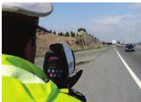
شکل ۳۰-۳ تعیین تندی خودروها به کمک اثر دوپلر
